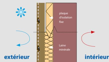
Bardage isolé et ventilé qui maintient la chaleur à l'intérieur et l'air froid à l'extérieur en hiver
