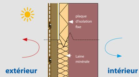
Bardage isolé et ventilé qui maintient la chaleur à l'extérieur et la fraîcheur à l'intérieur en été
